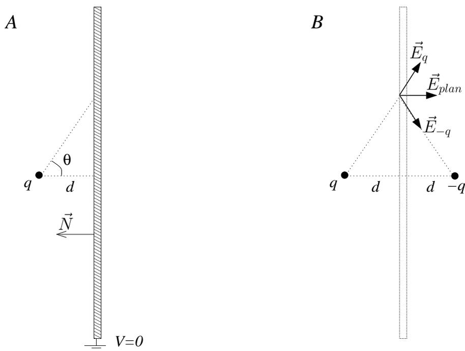
Le système  $B$  est un système sans le plan conducteur, avec une charge  $-q$  située symétriquement par rapport au plan. La région à gauche du plan est décrite par la même équation pour le potentiel (la distribution des charges est la même) pour les systèmes  $A$  et  $B$ , et la condition au bord  $V_{plan} = 0$  est bien vérifiée dans le système  $B$  grâce à la charge *image*  $-q$ .
