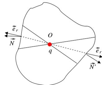
Considérez maintenant une charge \$q\$ qui n'est pas englobée par la surface (comme en figure ci-dessous). Dans ce cas le flux \$d\Phi\$ à travers \$dS\$ vaut :
