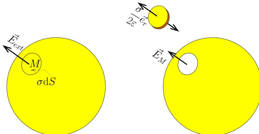
Considérons une sphère conductrice avec une charge surfacique  $\sigma$ . D'après le théorème de Coulomb on sait que le champ à la surface vaut  $\vec{E}_{ext} = \frac{\sigma}{\epsilon_0} \vec{e}_r$  et qu'il est nul à l'intérieur du conducteur.
